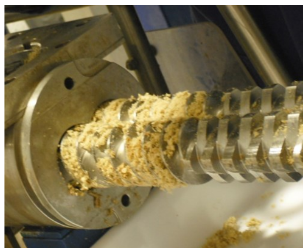
Process bis-vis étudié dans le cadre du projet VENDRE
