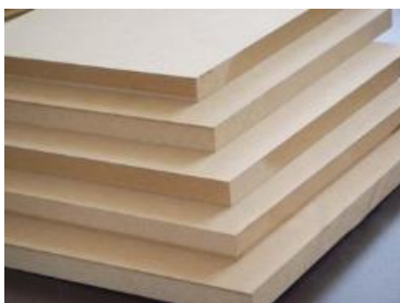
Figure 1 : Panneau MDF obtenu par voie sèche avec ajout de liant
