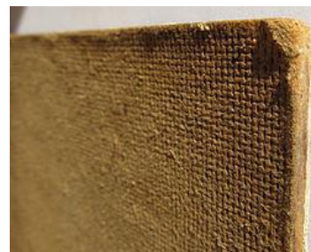
Figure 2 : Panneau de fibres dur obtenu par voie humide
