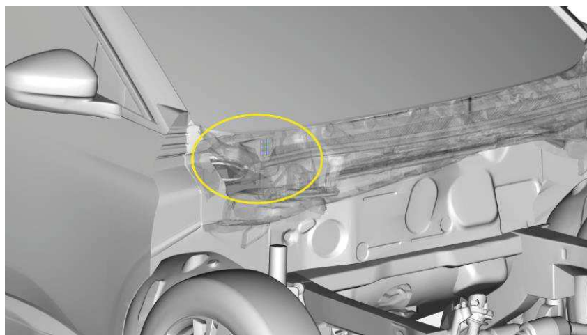
Figure 1 : Visualisation de l'emplacement de la baie d'auvent
