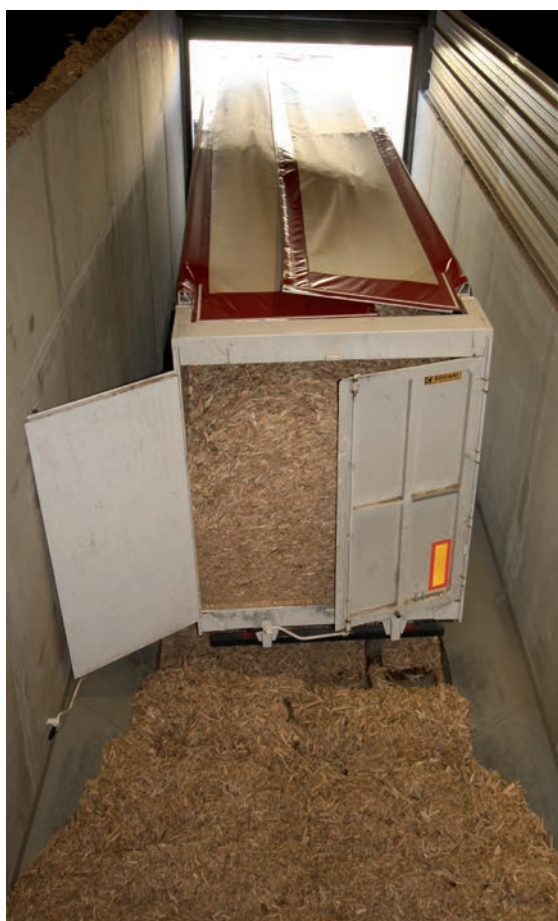
Approvisionnement du silo en plaquettes bois
