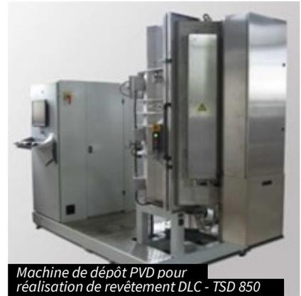
Machine de dépôt PVD pour réalisation de revêtement DLC - TSD 850
