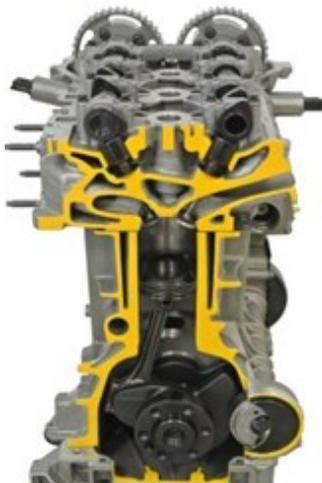
Moteur EB2 de PSA avec revêtement DLC sur les pièces mobiles
