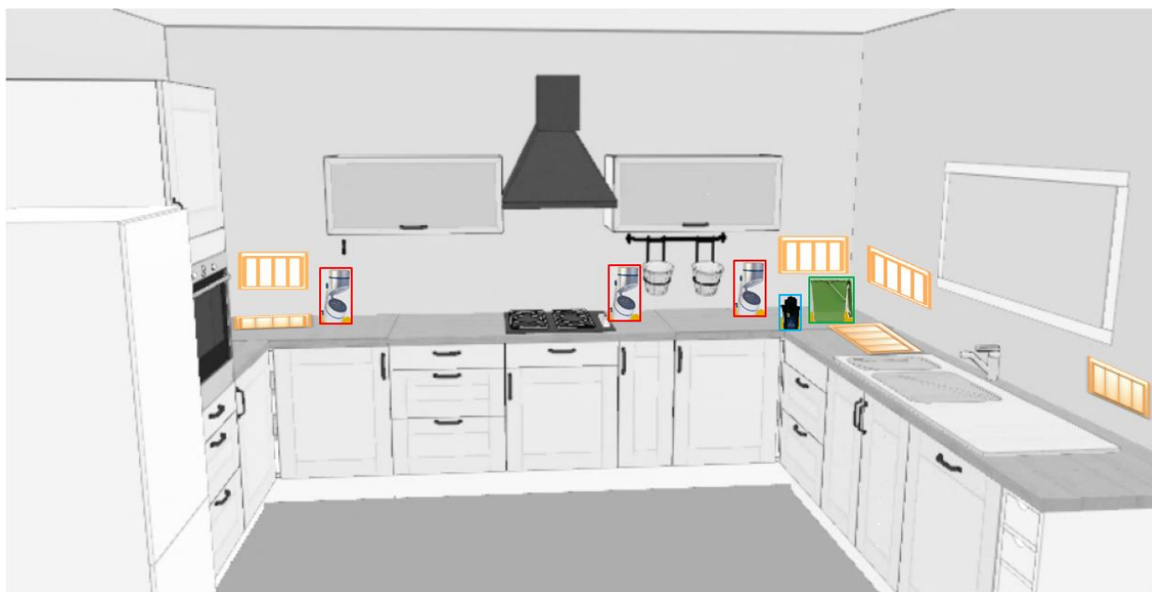
Figure 1 : Schéma représentatif des prélèvements réalisés dans la cuisine (en vert bio seau ; en rouge prélèvements d'air avec impacteur ; en bleu prélèvement d'air avec CIP ; en orange : prélèvements de poussière avec CEP).
