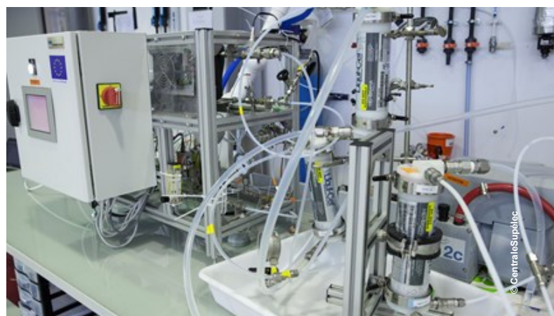
Procédé d'épuration du CO 2 par contacteur membranaire
