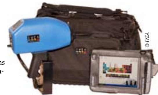
Appareil LIBS portable pour l'identification des déchets.
