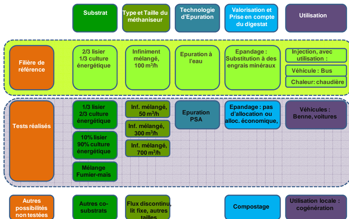
Figure 2 - Filière principale et tests réalisés
