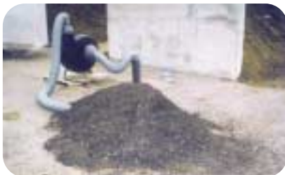
Système rustique d'aération forcée pour un mélange de boues + écorces
